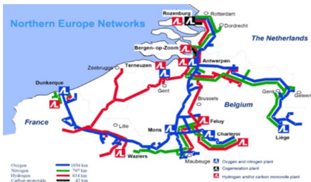
Fig. 35: Ondergronds leidingnet gassen (bron: Air Liquide)
